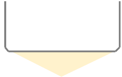
Figuur 2 Grafische weergave van grondverdringende paal met 'kegel' van zand
